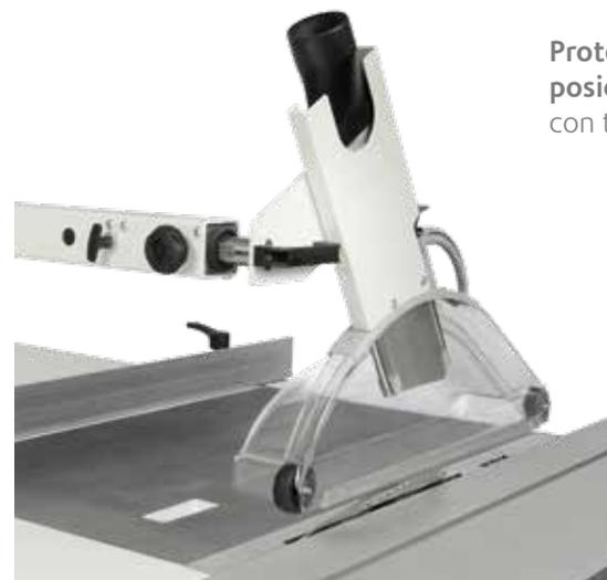
**Protección discos suspendida a dos posiciones**, para el trabajo en la sierra con total seguridad.
