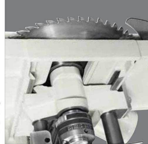
Los fulcros de rotación del grupo sierra tienen un diámetro de 120 mm y se apoyan en dos lunetas intermedias respecto a la bancada: solución rígida y fiable en el tiempo.
